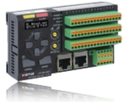
UR 시리즈 최대 256개 센서 통합 관리가 가능한 IO-Link Master
