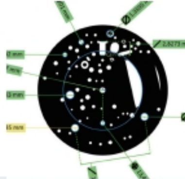
최대 71Mpx 컬러 카메라를 적용 가능하며, 최고 0.5μm 정밀도 구현
